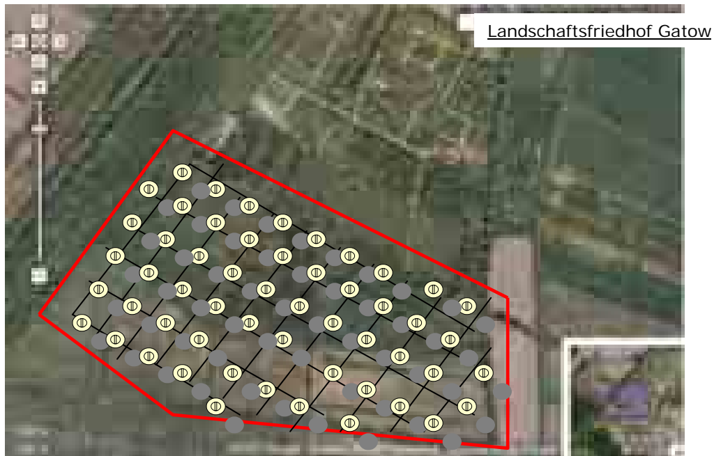
55 Solarpaneele auf dem Erweiterungsgelände des Friedhofs Berlin-Gatow. Entwurf: Behlau-Energiewende (Quelle: google-maps, Zugriff: 31.08.2007)
